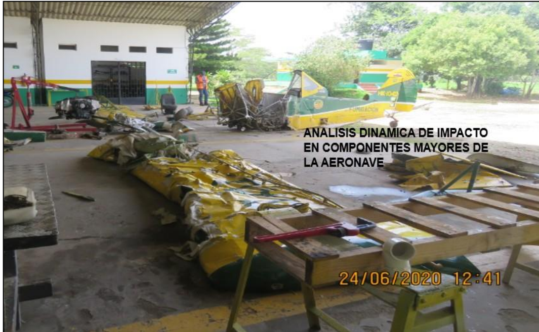
Fotografía No. 8 – Reconstrucción de la aeronave para analizar la dinámica de impacto.
